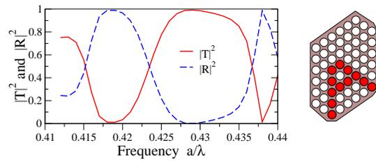
(d)  $120^\circ$  waveguide bend for triangular lattice.
